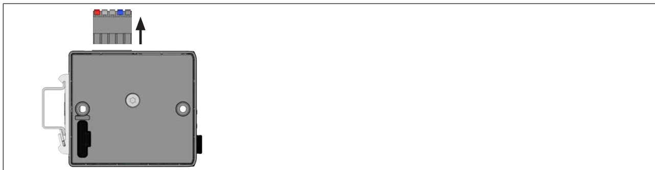
Figure 25 : Retirer la borne à ressort 5 pôles
