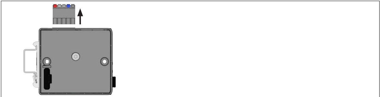
Figure 29 : Retirer la borne à ressort 5 pôles
