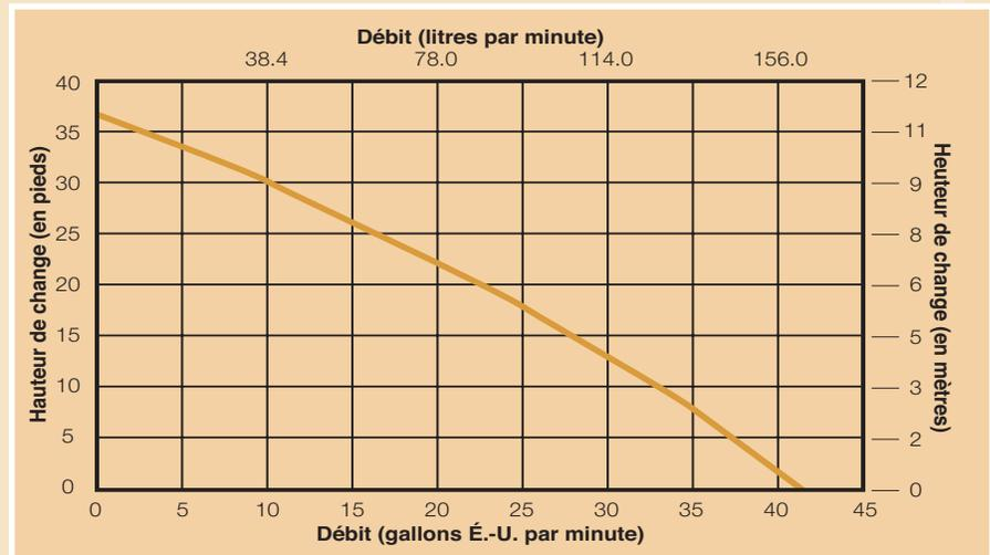
**Remarque :** Hauteur de charge maximale de 11 m (36 pi). La hauteur d'élévation maximale, en supposant que l'évacuation latérale de 45,7 m (150 pi) par un tuyau de 2,54 cm (1 po) est de 7,62 (25 pi). Consulter le fabricant pour connaître la taille adéquate et la méthode de calcul de la perte de pression.
