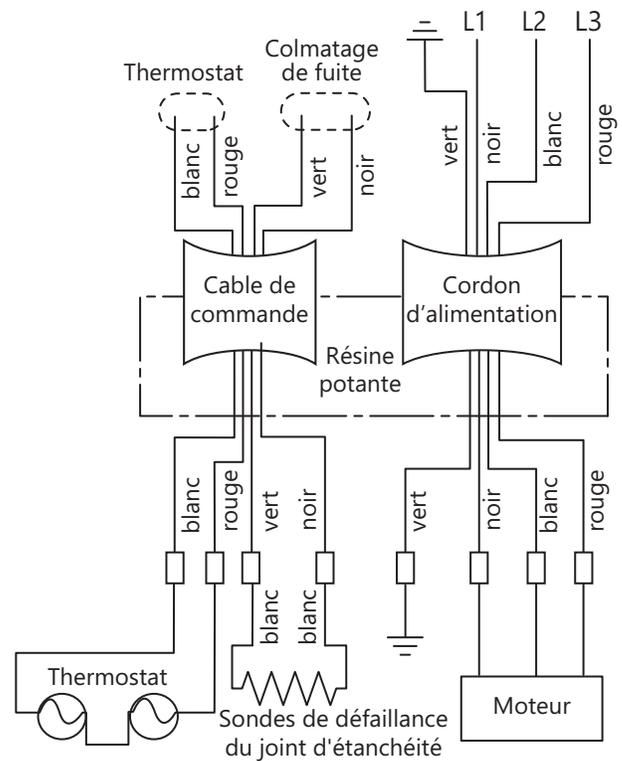
Figure 2. Schéma de câblage pour modèles triphasés
