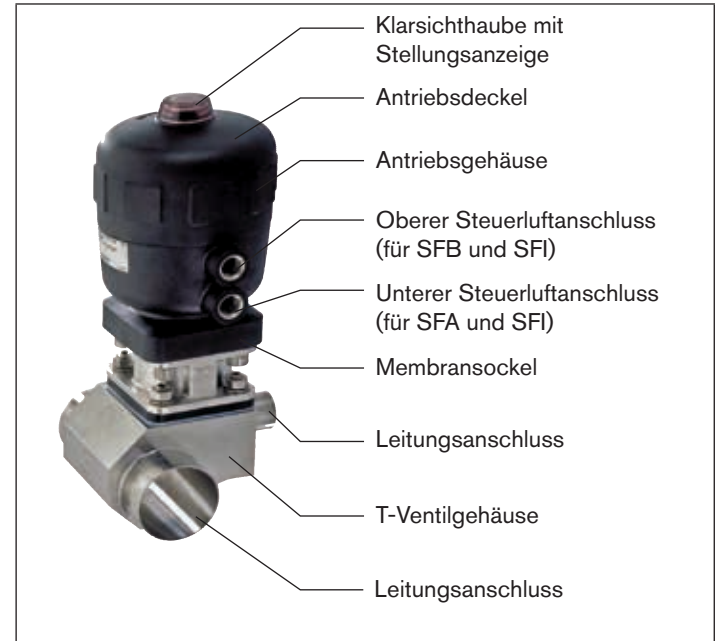
Bild 22: Aufbau und Beschreibung Typ 2032
