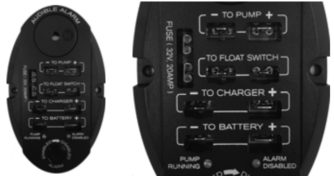
Figura 8. Bloque de terminales
