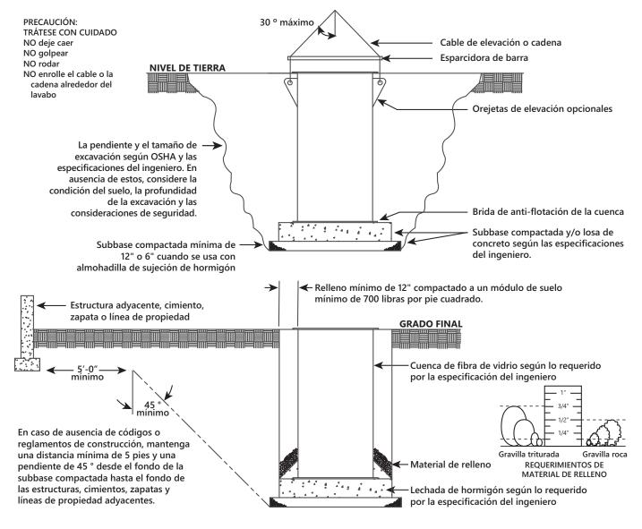
NOTA: La intención de estas instrucciones de instalación e ilustración es garantizar que no se produzcan daños o fallas prematuras en la cuenca. Estas instrucciones de instalación y la ilustración no están diseñadas para evitar los procedimientos normales de seguridad que deben seguirse para evitar lesiones al personal.
