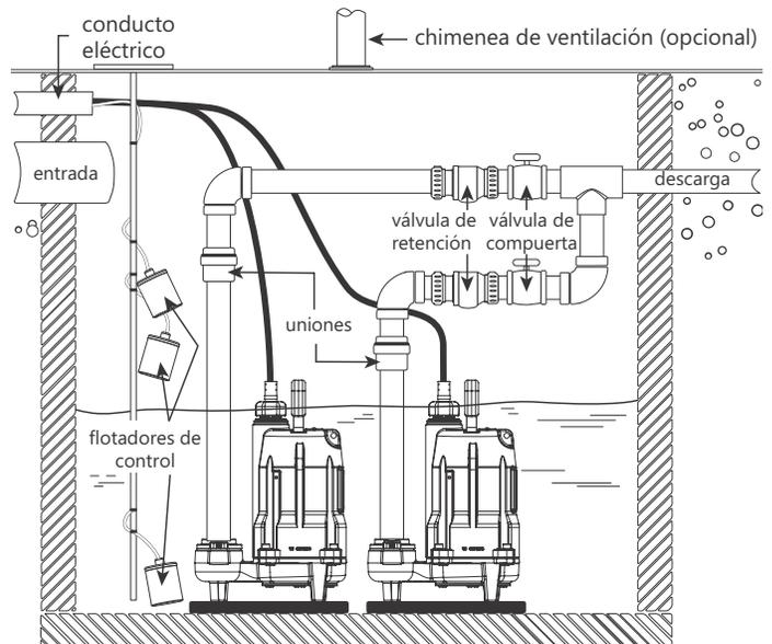
Figura 5. Instalación típica de sistema duplex (pueden presentarse variaciones)
