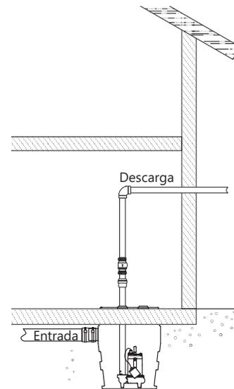
Figura 3. Instalación típica de bomba de sumidero sumergible (pueden presentarse variaciones)
