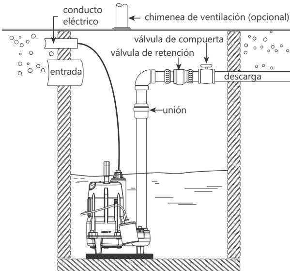
Figura 4. Instalación típica de sistema simplex (pueden presentarse variaciones)
