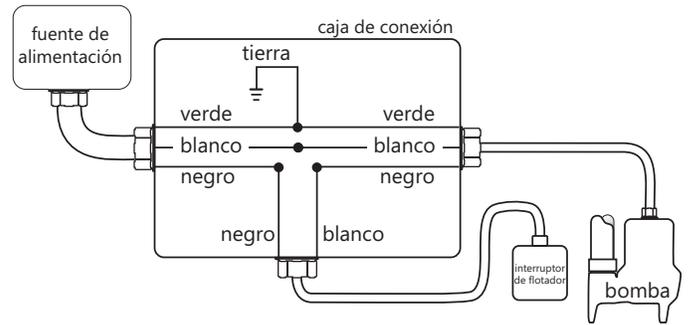
Figura 2. Cableado directo de bombas automáticas monofásicas de 115 V o 208/230 V
