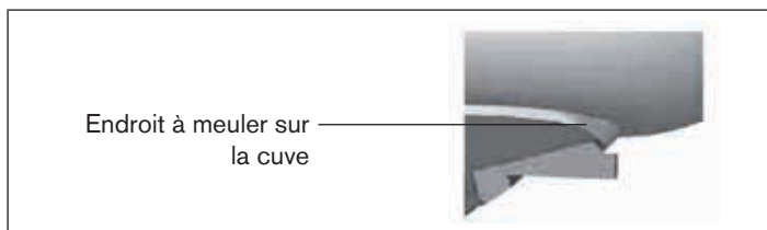
Fig. 10 : Endroit à meuler sur la cuve
